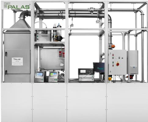
Um Qualität und Effizienz von Filterelementen zuverlässig zu bestimmen, muss neben der Gesamtpenetration auch der Energieverbrauch (Druckverlust), die Beladung und der Partikelabscheidegrad genau geprüft werden.
